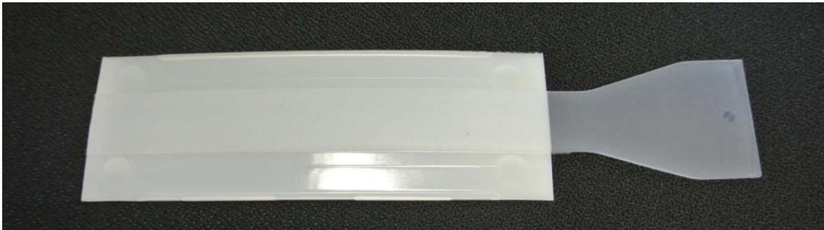
**Bild 1: Probekörper aus Silikon und PA 6 nach VDI Richtlinie 2019**
